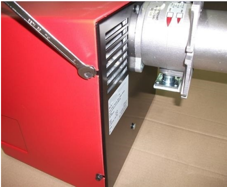
1) Снять кожух, ослабив 4 винта;
