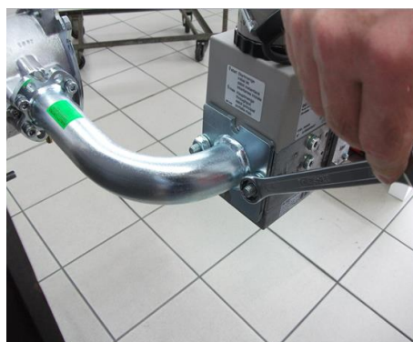
8) установить электроклапан и Прикрепить из фланец;
