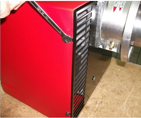
1) Снять кожух, ослабив 4 винта;
