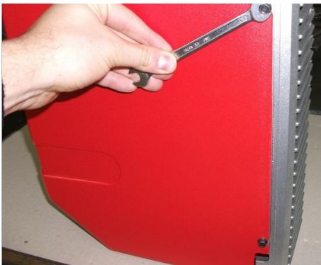
1) Снять кожух, ослабив 4 винта;
