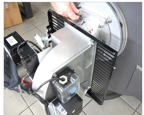
6) Зафиксировать горелки на котел;
